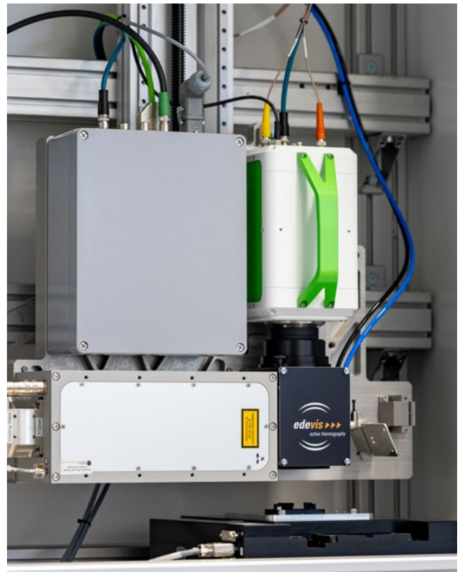
Abbildung 4: INSIGHT-L Prüfkopf mit aktivem Pilotlaser
