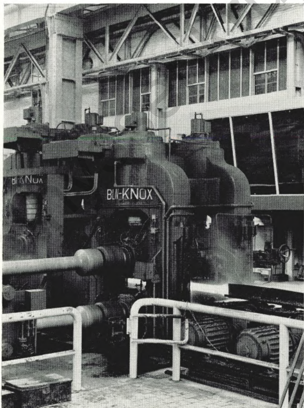
OBEN: Der Übergabe-Zangenkran bringt ein Vorprofil von der Straße 1; auf dem Rollgang der zum Fertiggerüst laufende Träger — UNTEN links: Stauchgerüst und Universalgerüst beim Walzen der ersten Träger; im Hintergrund die Steuerbühne — rechts: Träger im Universalgerüst
