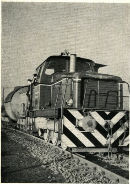
Eine unserer 500-PS-Diesellokomotiven, die gemeinsam mit der Lokomotivfirma auf der Westfalenhütte entwickelt wurde und sich nicht nur durch hohe Leistung, sondern auch durch besonders gute Sichtmöglichkeiten auszeichnet.
