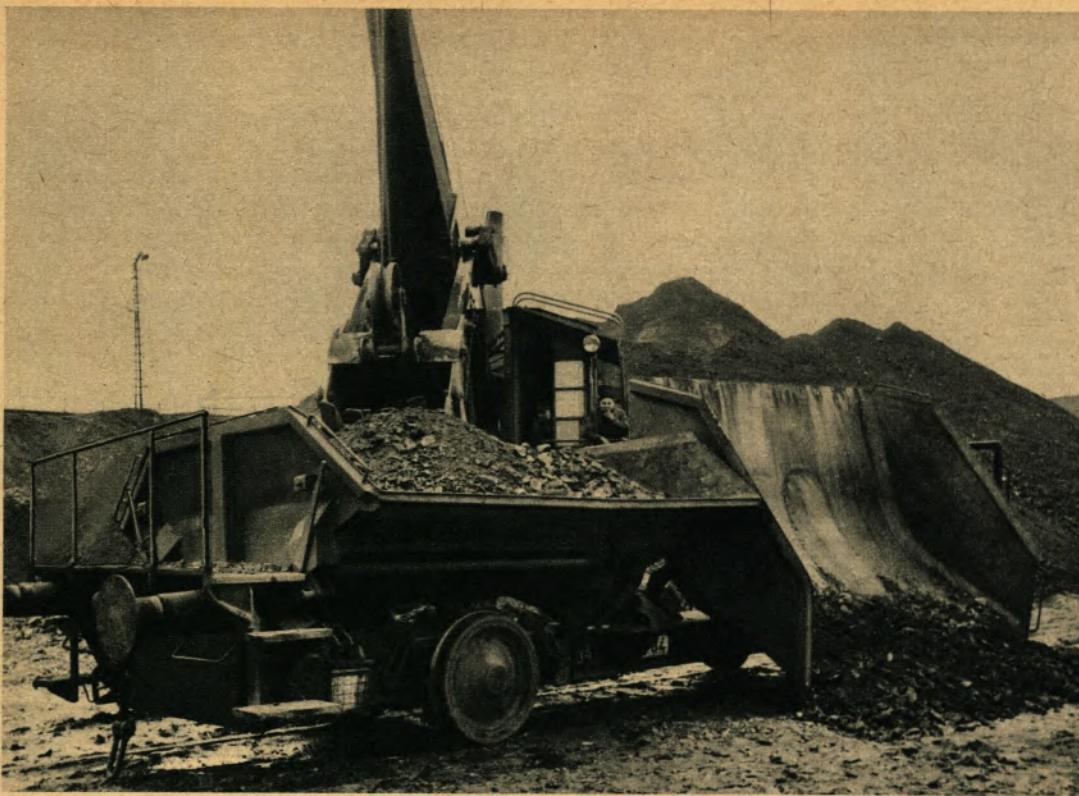
◀ Ein erzbeladener „Flachmuldenkipper“ von Orenstein & Koppel bei der Entladung am Erzlager
