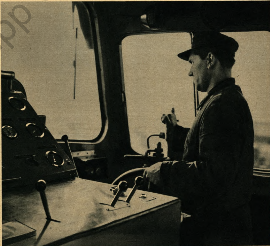
► Im Führerstand der Diesellok Typ Westfalenhütte. Rudolf Wiederstein bedient mit der linken Hand das Steuerrad, das die Funktion des Gashebels besitzt, mit der rechten die Druckluftbremse. Ganz oben ist der Mikrofonlautsprecher der Rangierfunkanlage zu erkennen
