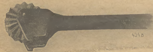
Abdrehwerkzeug, das unrunde Schleifscheiben wieder schlagfrei macht.
