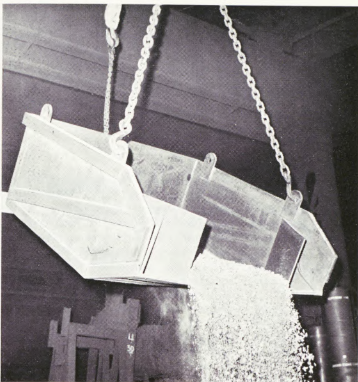
Die beiden Chargiermethoden: links mit Rutsche und Leitblechen, rechts im Chargierkorb
