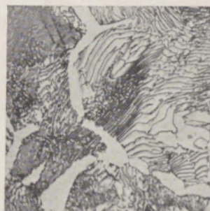
derselbe unlegierte Stahl nach einer Glühung (600fach vergrößert)
