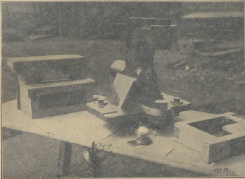
Bild 21: Facharbeit für Modellschreiner und Eisenformer: Weichenbod (Modell und Kernkästen)
