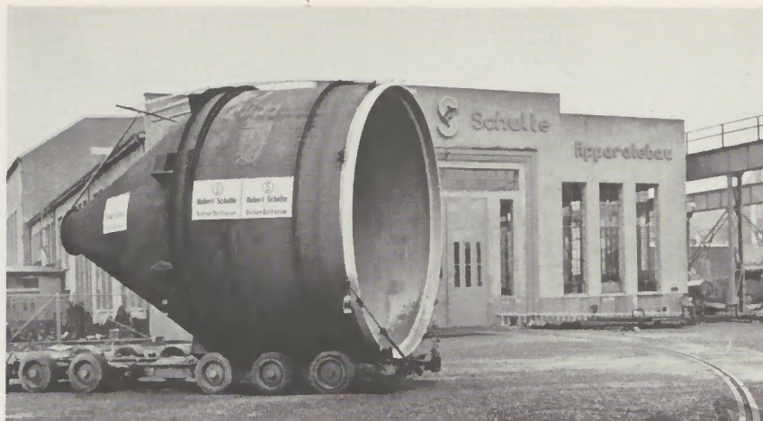
Verbleites Reaktionsgefäß, 4800 mm \phi , Gewicht ca. 20 000 kg
