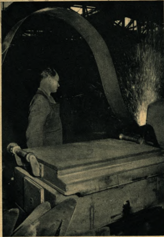
Beim Zusammenschweißen des Bandes für das nachfolgende Profilwalzen.
