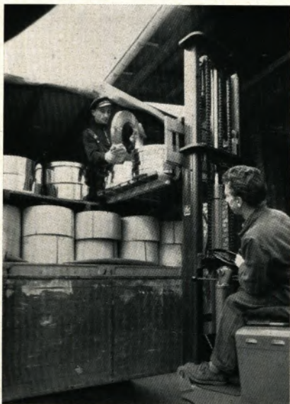
Das Walzgut der Trierer Walzwerk AG wird innerhalb des Werkes mit modernen Hubstaplern befördert, damit beim Transport und beim Verladen des Materials die hochfeinen Oberflächen nicht beschädigt werden
