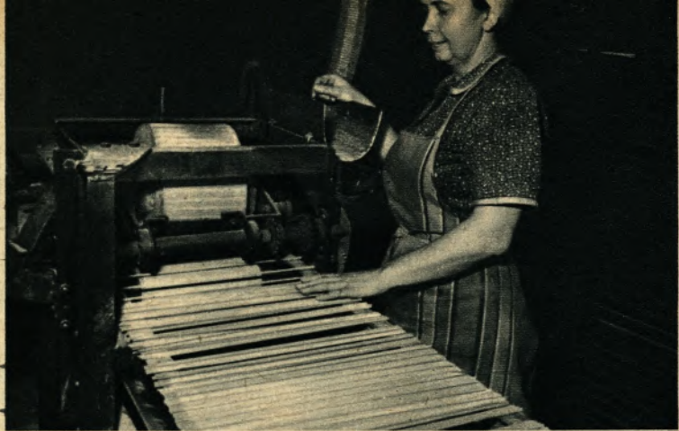
Bei der Fließbandfertigung von Schweißelektroden: an der Bürstmaschine
