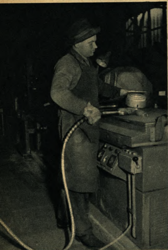
Vor dem Zusammenschweißen werden die Schweißflächen gesäubert.
