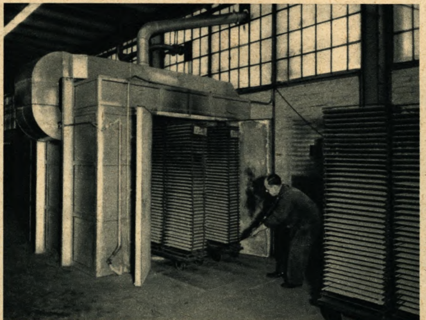
Ein Hochtemperaturofen zur Herstellung von Schweißelektroden.
