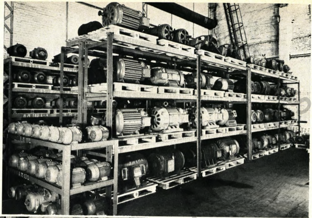
Rechts: Palettenregale im Elektromotorenlager eines großen Industriebetriebes.
