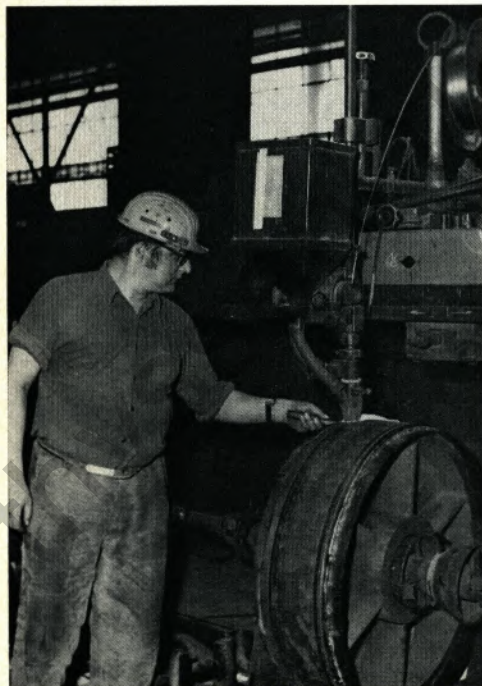
Auftragsschweißung eines Kranlaufrades mit dem Unterpulverschweißgerät. Am Gerät Schweißer Siegfried Schellhammer.
