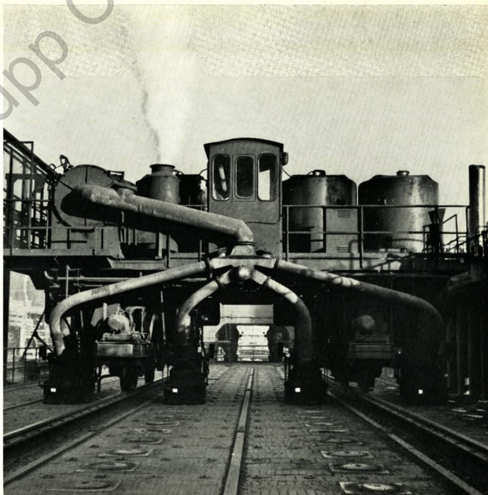
Abb. 4: Die Auswirkung der besseren Entstaubung der Füllgase mit Hilfe des neuen Füllwagens ist verblüffend: schneeweißer Wasserdampf verläßt den Abzugsschlot des Entstaubers
