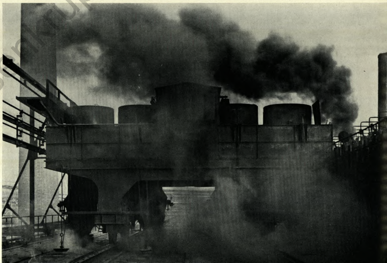
Abb. 2: Beim Füllen mit dem alten Wagen wird dieser von einer dichten Staub- und Füllgaswolke eingehüllt
