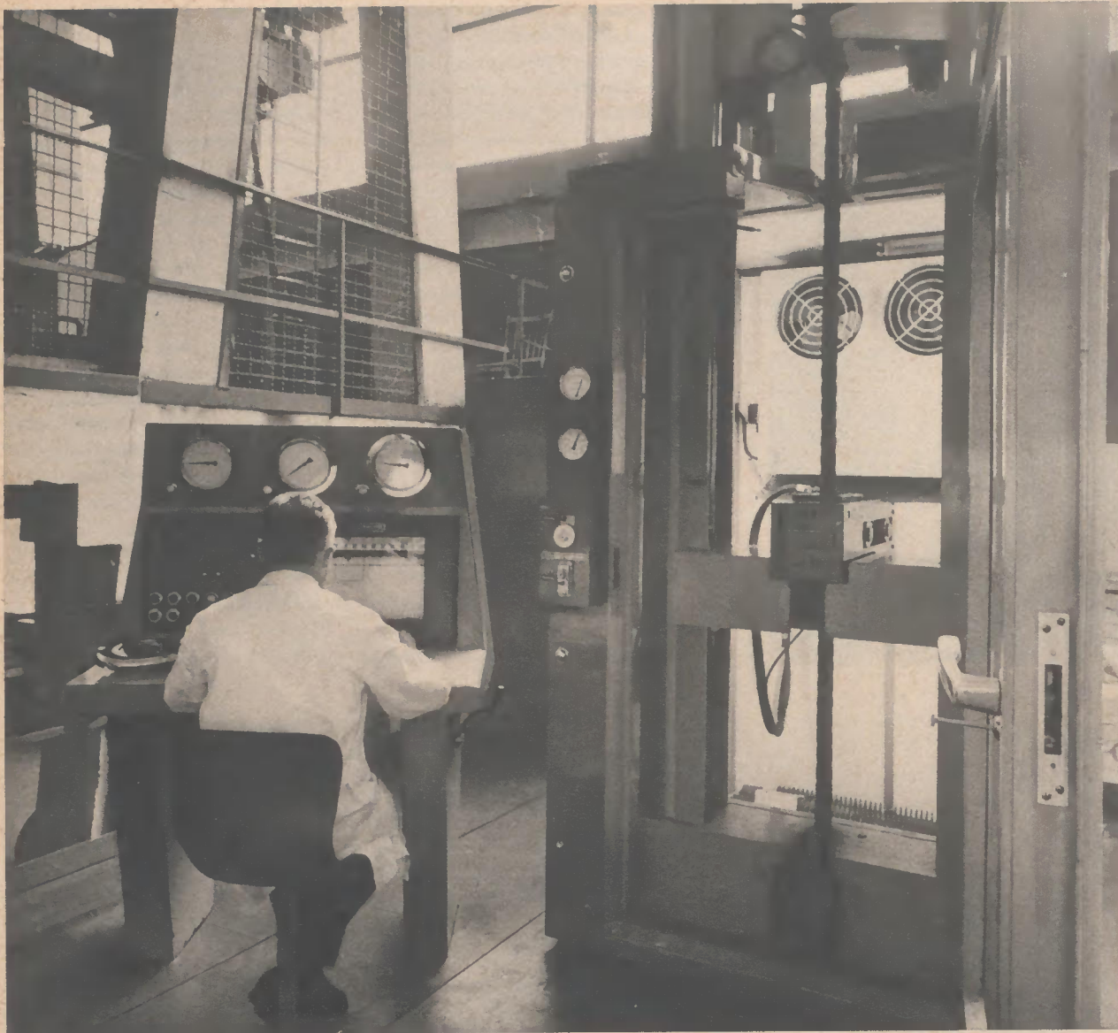
▲ Ingenieur Dornburg am Steuerpult des Prüfstandes für die Ermittlung der Reibungswerte zwischen Seil und Treibscheibenfutter. Eine Klimakammer macht die Untersuchungen zwischen -12 Grad und +50 Grad möglich
