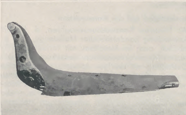
Abb. 5. Fahrgestellbein. Bruch: Schnitt A-B der Abb. 6. Durch kleine Fehlstellen wird die Festigkeit kaum beeinflusst Abb. 6. Fahrgestellbein aus Elektronguß; Gewicht 47 kg
