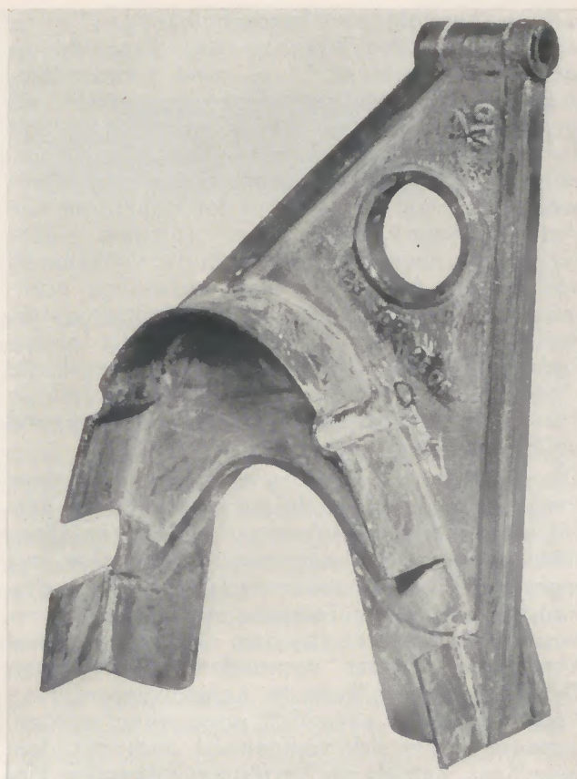
Abb. 2. Flügelanschluß aus Stahlguß (vgl. Abb. 18), entsprechend der Flügelform stark unterschrittene Flansche
