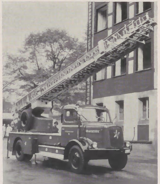
Unser Bild oben zeigt das neue Henschel-Fahrzeug mit der Metz-Leiter, die nicht nur in die Höhe, sondern auch waagrecht ausgefahren werden kann. Links: Sämtliche Henschel-Fahrzeuge aus dem Wagenpark der Kasseler Feuerwehr.
