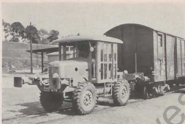
Zugmaschine „Pousse-Waggons“ mit Allradantrieb.
