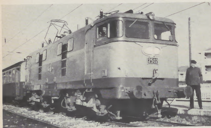
Bild 44 Elektrische Bo'Bo'-Wechselstrom-Lokomotive für die Portugiesische Staatsbahn, 50 Hz – 25 000 V
