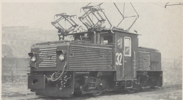
Bild 15 Bo-Zweikraft-Lokomotive, Spurweite 900 mm, Dienstgewicht 27-30 t, Leistung bei Dieselmotorbetrieb 106 kW, bei Oberleitungsbetrieb 214-360 kW bei 1200 V
