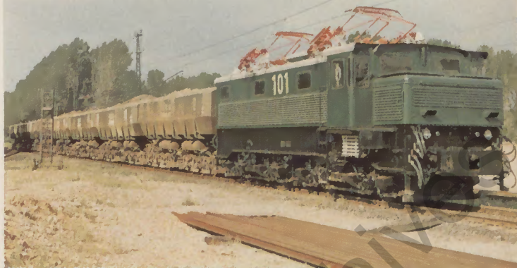
Bild 12 Bo'Bo'-Umformer-Lokomotive, Spurweite 1435 mm, Dienstgew. 128 t, Leistg. 1480 kW bei 760 V u. 1860 kW bei 960 V
