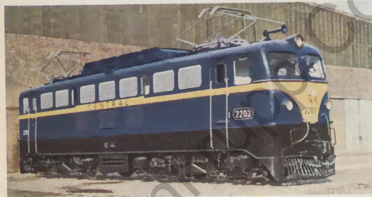
Bild 45 Elektrische Bo'Bo'-Gleichstrom-Lokomotive für die Zentralbahn Brasilien, 3000 V
