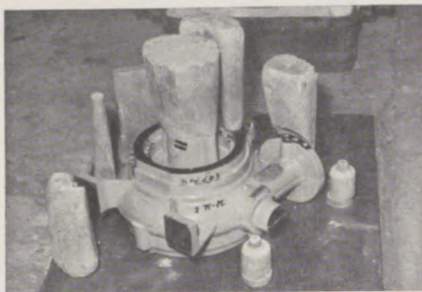
Bild 3 Holzmodell des Pumpengehäuses und die benötigten Steiger, Druckmasseln und Trichter
