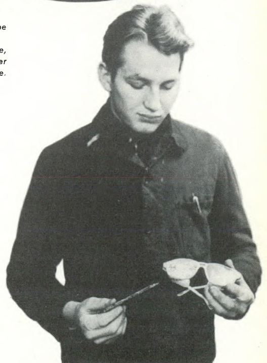
Hermann Broda mit der zerstörten Schutzbrille und dem abgerissenen Teil der Schleifscheibe. Nur eine geringfügige Platzwunde hat er von diesem Unfall davongetragen.
