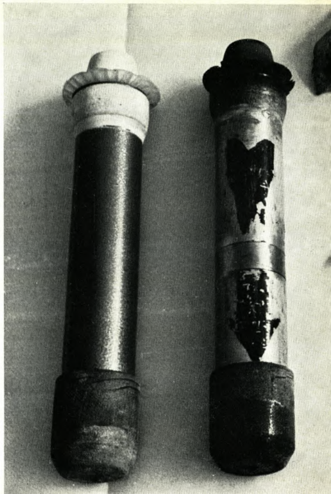
Rohrpostbüchsen. Links eine neue Stahlbüchse, rechts eine aufgearbeitete Büchse aus Aluminium (Laufleistung etwa 600 km).
