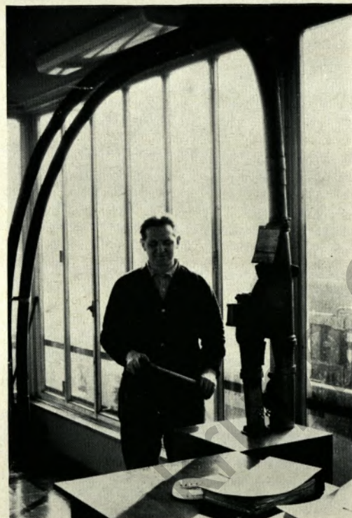
Sende- und Empfangsstation mit handbetätigter Weiche in der Waage Oberhausen West. Der Verwiegler, Herr Kalinke, prüft vor dem Absenden der Büchse noch einmal den richtigen Sitz der Verschlusskappe.
