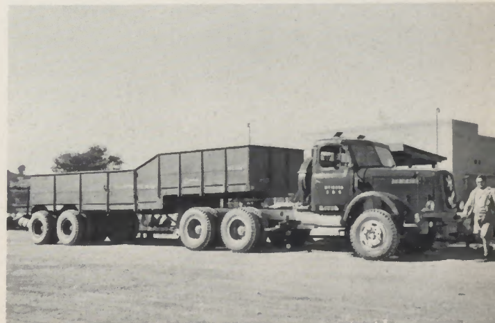
Abb. 5 Henschel Dreiachser HS 3-170 als Sattelschlepper mit Riesenaufleger in Stahlbauart im südafrikanischen Einsatz
