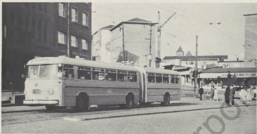
Abb. 3 Henschel HS 160 USL als Gelenkbus im Einsatz. Dieser Omnibus ist mit Luftfederung ausgerüstet, die dem Bus hervorragende Fahreigenschaften gibt
