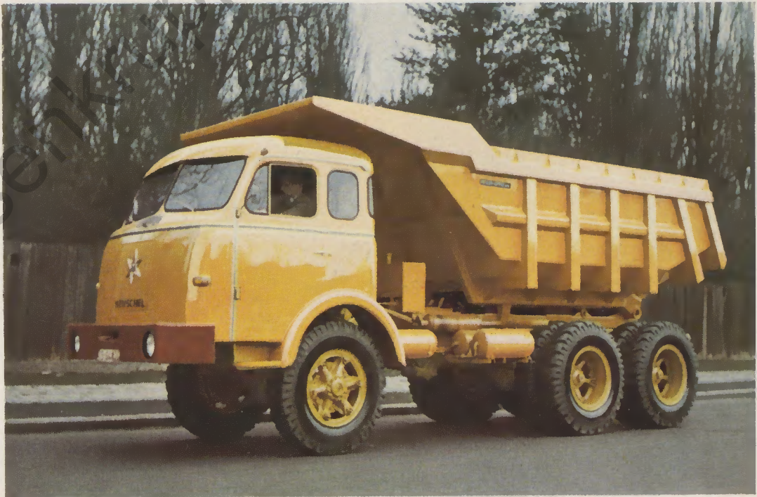
Henschel HS 3-180 mit Henschel Diesel 180 PS als Dreiachs-Muldenkipper für den Eschweiler Bergwerksverein, Kohlscheid/Aachen. Die Nutzlast dieses Fahrzeugs beträgt 20 t
