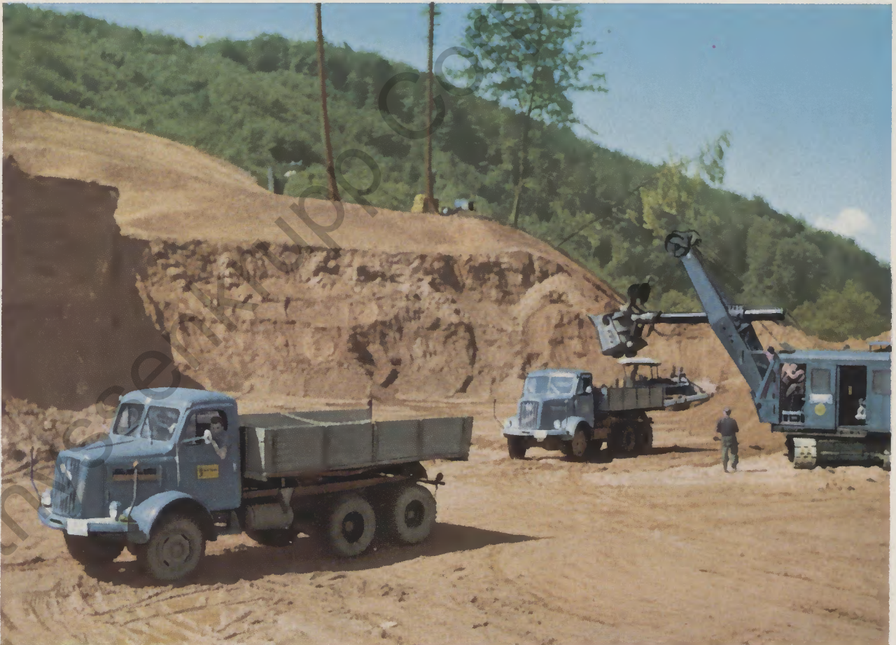
10 Henschel Dreiachser als Dreiseiten-Kipper des neuen Typs HS 3-125 und eine Anzahl der bekannten Zweiachser Henschel HS 100 und HS 120 Allrad-Kipper sind im 10-Stunden-Betrieb beim Autobahnbau Landstuhl – Saarbrücken eingesetzt
