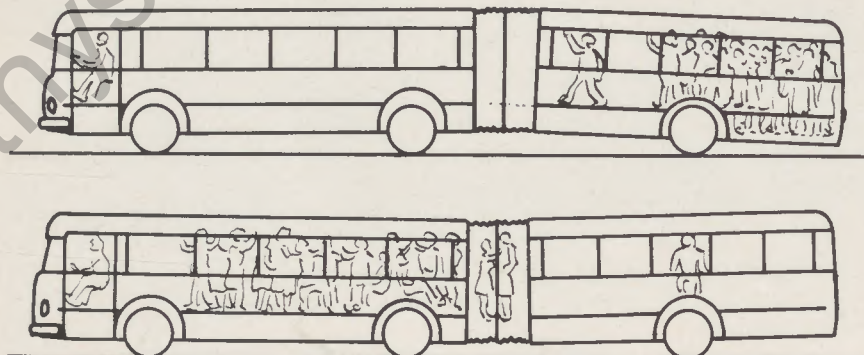
Abb. 5 Zustand beim Gelenkbus mit normaler Blattfederung zwischen zwei Haltestellen: oben: Veränderung der Längsachse nach oben bei einseitiger Belastung beim Einstieg unten: Veränderung der Längsachse nach unten bei einseitiger Belastung beim Durchgang in den Motorwagen
