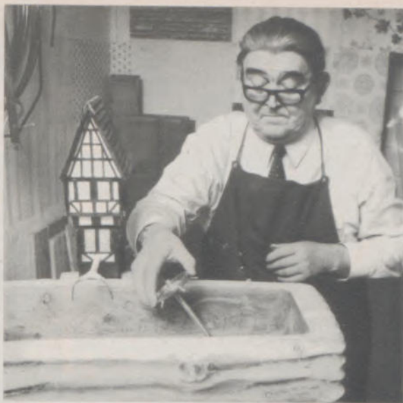
◀ Um das Mischen und Gießen zu beschleunigen, hat Nicol Puchta einen Mischpropeller konstruiert
