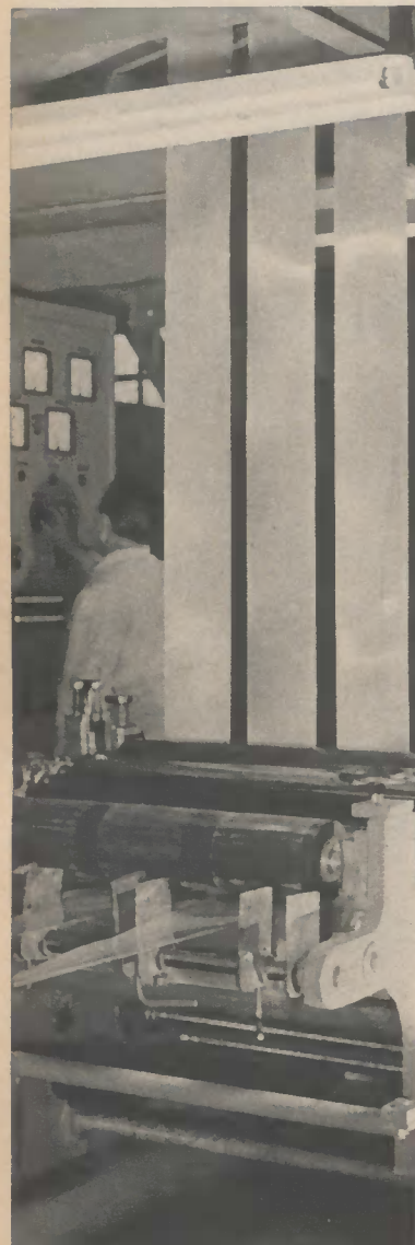
▲ Im Werk Trier werden oberflächenveredelte Bänder aller Art hergestellt. Mit dieser Maschine werden Bandstähle lackiert
