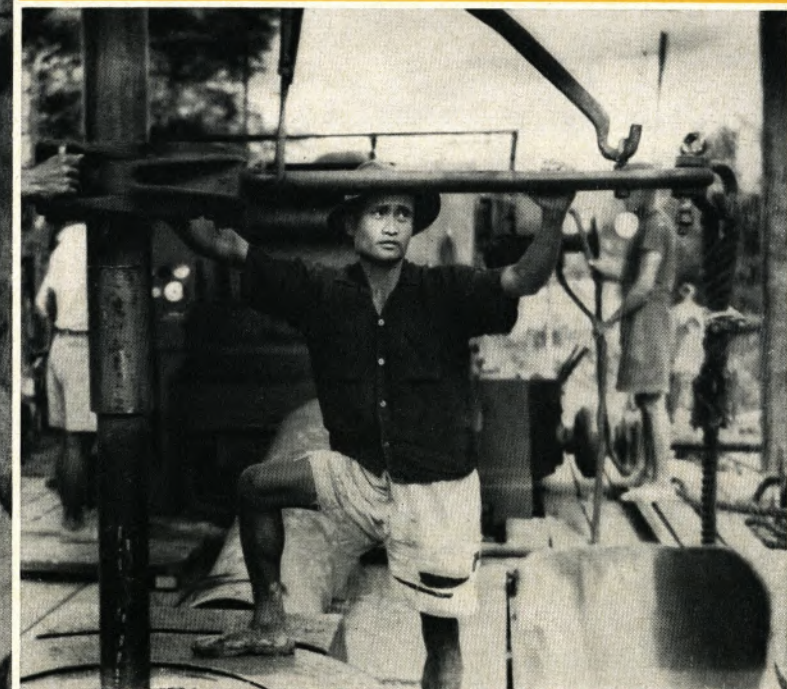
Der Rollenmeißel senkt sich durch den Drehtisch in das Bohrloch. Ein eindrucksvolles Bild aus dem jüngsten Ölland der Welt, der kanadischen Provinz Alberta.
