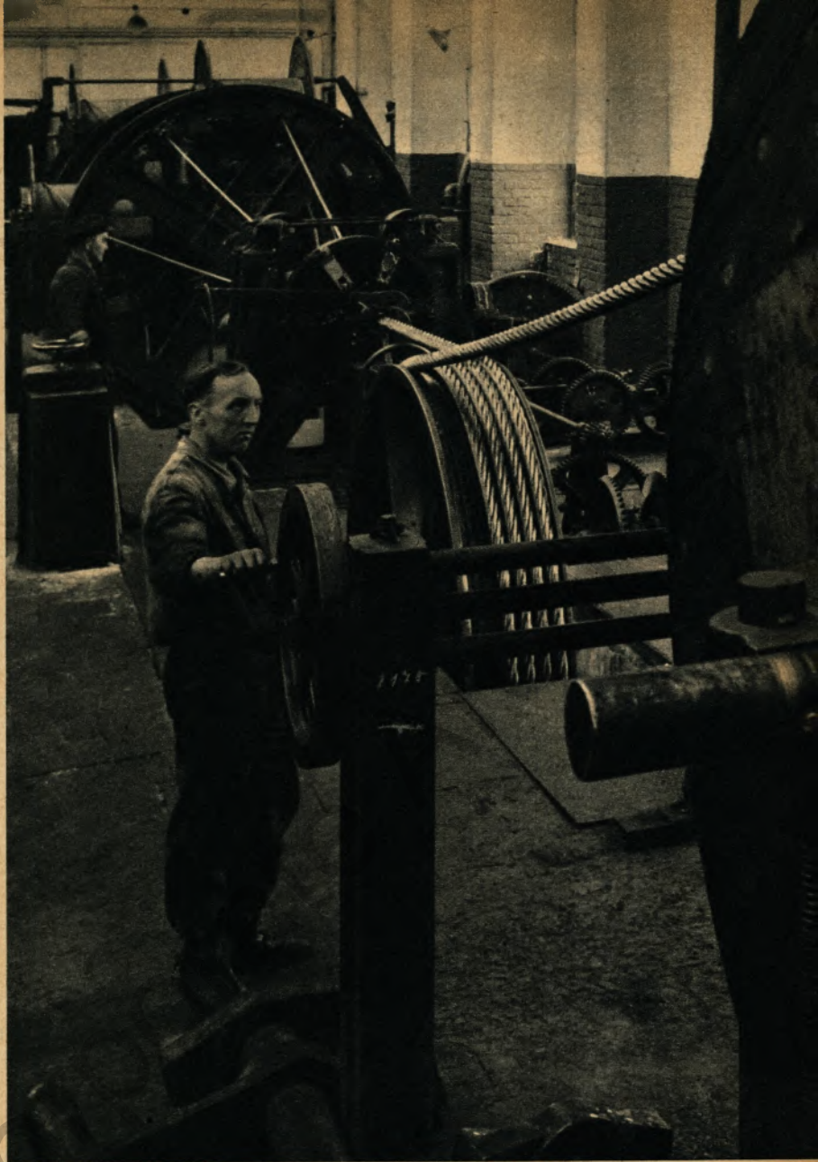
Auf dieser Maschine werden größte Drahtseile hergestellt.
