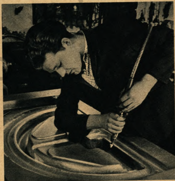
Der »letzte Schliff« an einer Gesenkform
