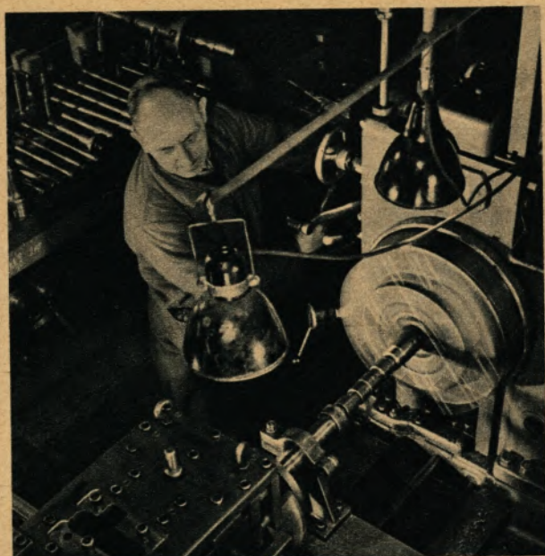
Auf der Drehbank werden Wellen bearbeitet
