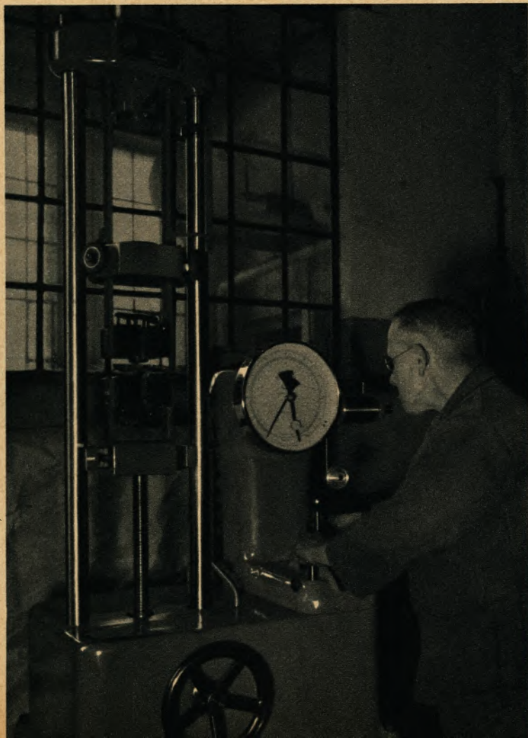
Hier werden Drähte und Drahtseile sorgfältig geprüft.
