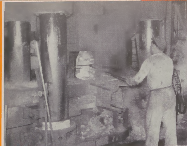
2 Stauchen eines Bandagenblockes unter der 2500-t-Press
