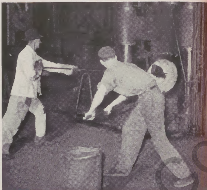
5 Auswalzen des Ringes zu einer Bandage für die Bundesbahn
