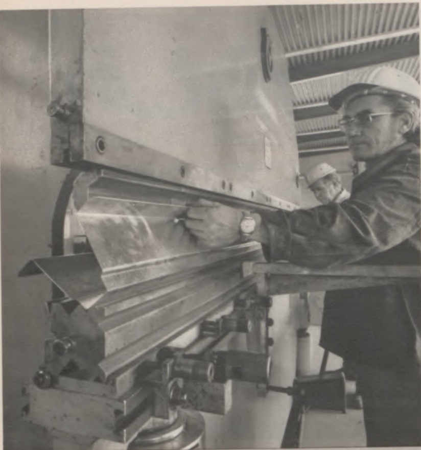
In der Versuchswerkstatt nimmt die Zeichnung Gestalt an: Auf der Abkantpresse biegen Ernst Marschinski und Willi Friedhoff das Profil der Außenhaut
