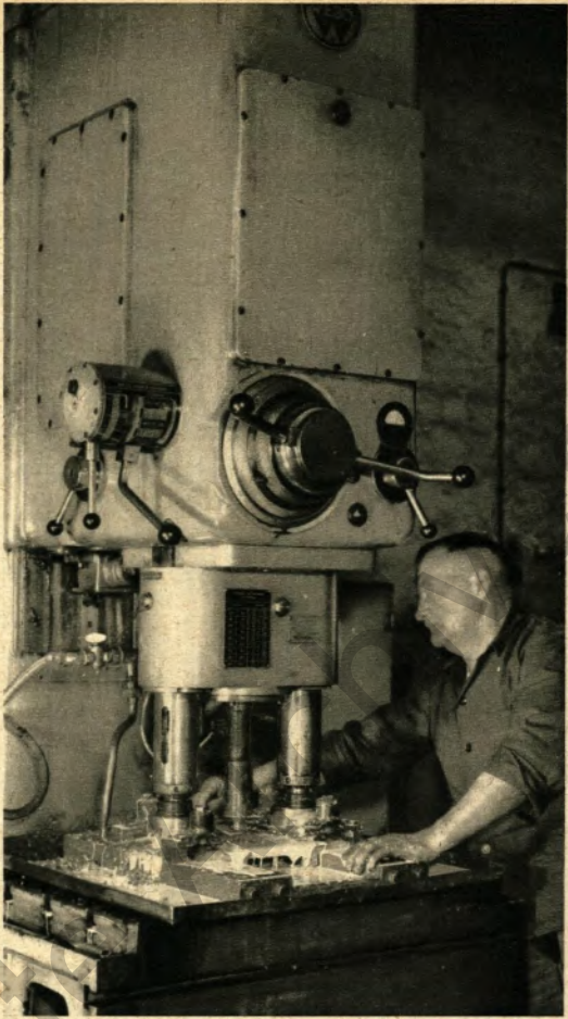
▲ Franz Kling von der Dörken AG in Gevelsberg fräst an der Universalfräsmaschine Rippenplatten – eines der wichtigsten für die Eisenbahn bestimmten Erzeugnisse der Dörken AG
