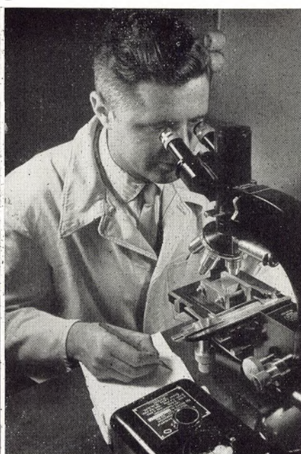
Das kaltgewalzte Feinblech schließlich wird in der Versuchsanstalt sehr genau unter die Lupe genommen und auf seine Qualität geprüft. Links eine Reißprobe, daneben mikroskopische Untersuchung. Unten: So sieht das Mikroskop das Kristallisationsgefüge und den Reinheitsgrad von kaltgewalztem Feinblech
