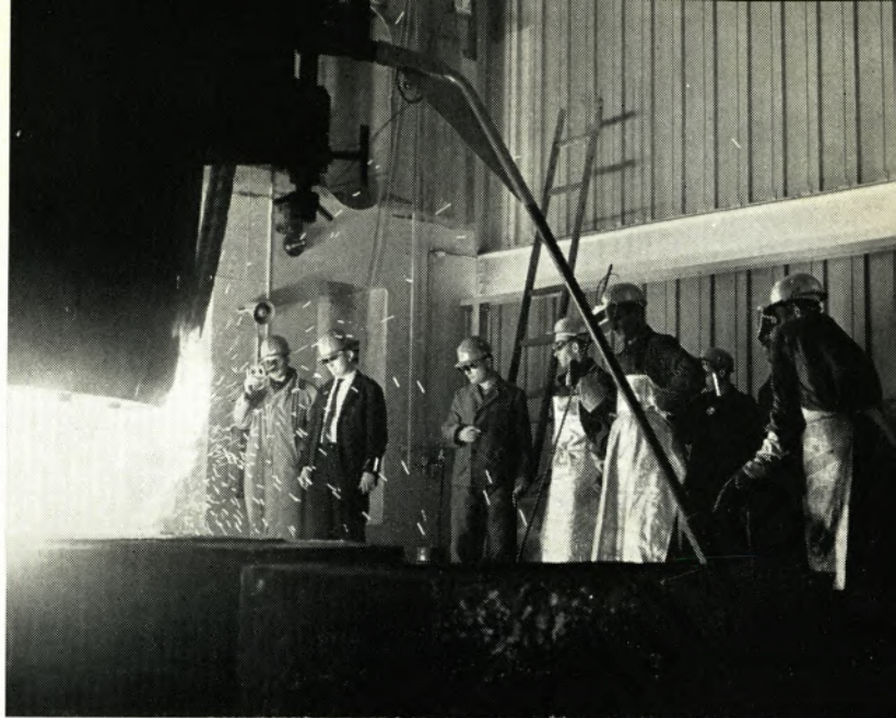
Das Gießen von Brammenkokillen im neuen Oxygen-Stahlwerk.
