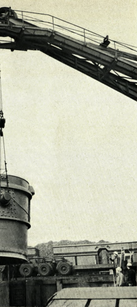
Zwei 16-t- Portalkrane heben eine Panne aus dem Schiff.
