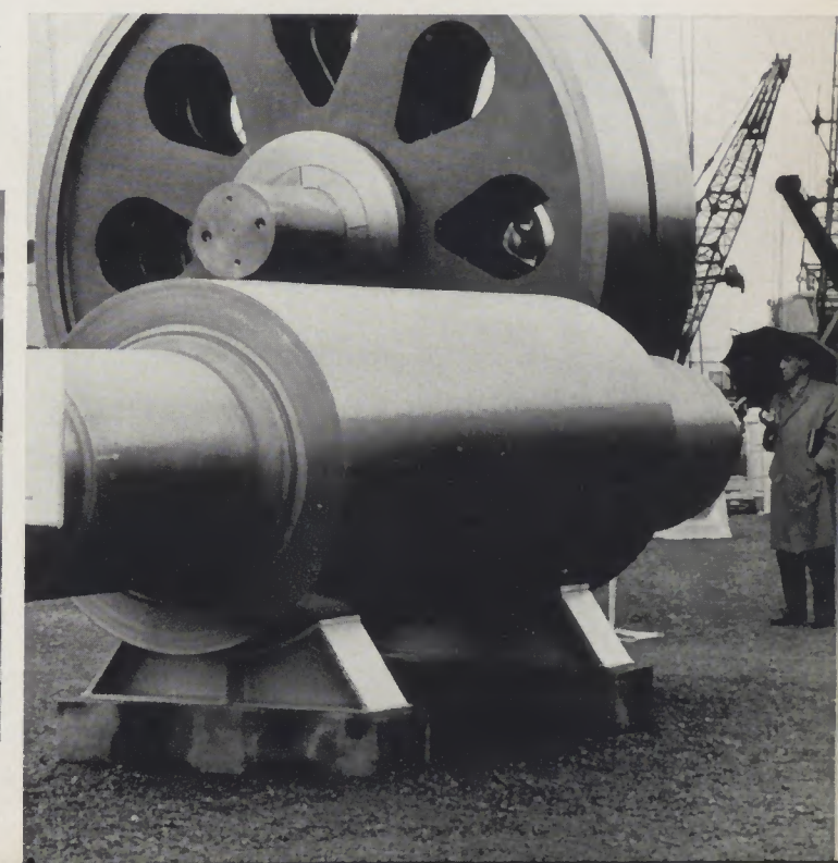
Spiegelnde Flächen: Ing. Ackermann achtete darauf, daß die mechanisch polierten Kalandarwalzen blitzblank blieben
