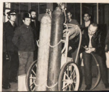
Gerhard Schneider (BEFA) stellt einen neuen Flaschenwagen vor, der auch für den Krantransport geeignet ist
