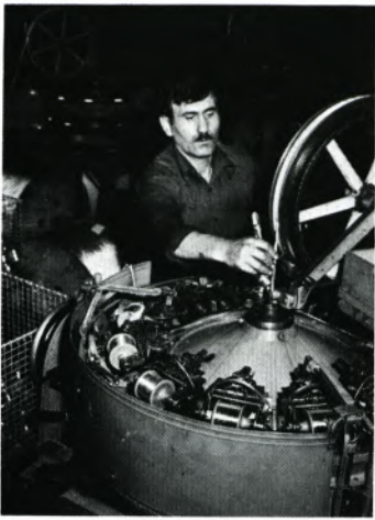
Unser Titelbild zeigt das Umflechten der Isolation von Koaxialkabel mit versilberten Kupferdrähten: Nizamettin Özen hat gerade die Drähte einer neuen Flechtspule angehängt.
