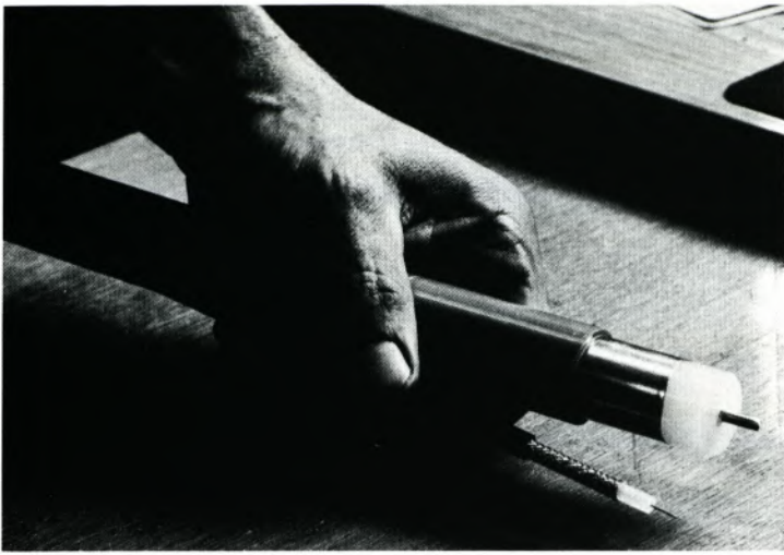
Koaxialkabel: Gegenüberstellung eines Hausanschlußkabels von sechs Millimeter und eines Erdkoaxialkabels von dreißig Millimeter Außendurchmesser, die beide mit gleicher Präzision gefertigt sind.
