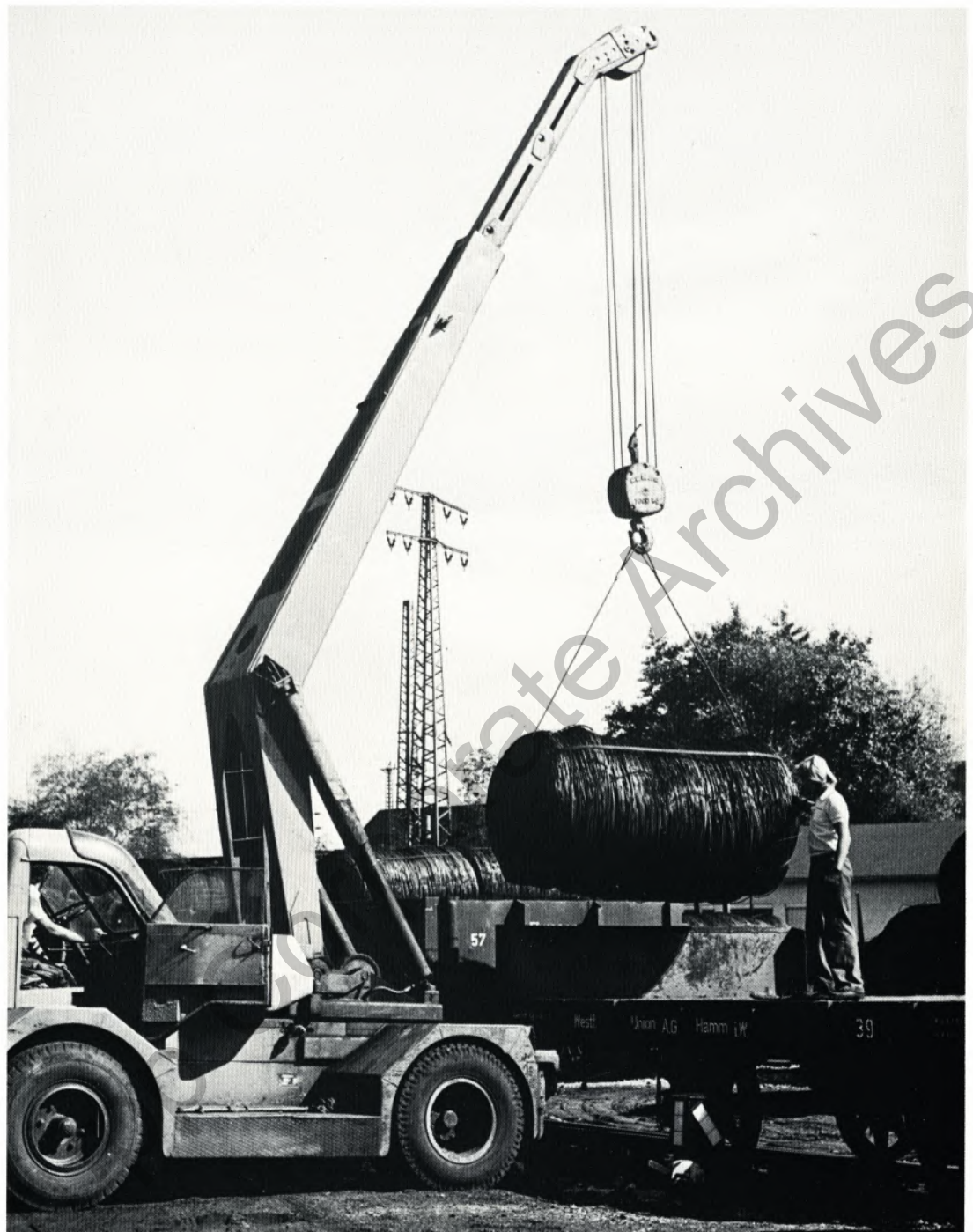
Aufladen von Walzdraht mit Autokran im Freien.
