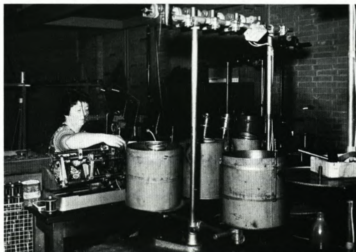
Extrusion der Isolation: Der Kupferdraht durchläuft den Spritzkopf des Extruders und wird mit Polyäthylen umspritzt. Bild unten: Fachen von Geflechtsdrähten: Die im Bild nicht sichtbaren Kupferdrähte von 0,10 bis 0,15 Millimeter Durchmesser werden von Spulen, die in den Töpfen stehen, mit hoher Geschwindigkeit abgezogen und auf eine kleine Fachspule zusammengespuht. Fächerin Else Pfapp überwacht diese Arbeit.
