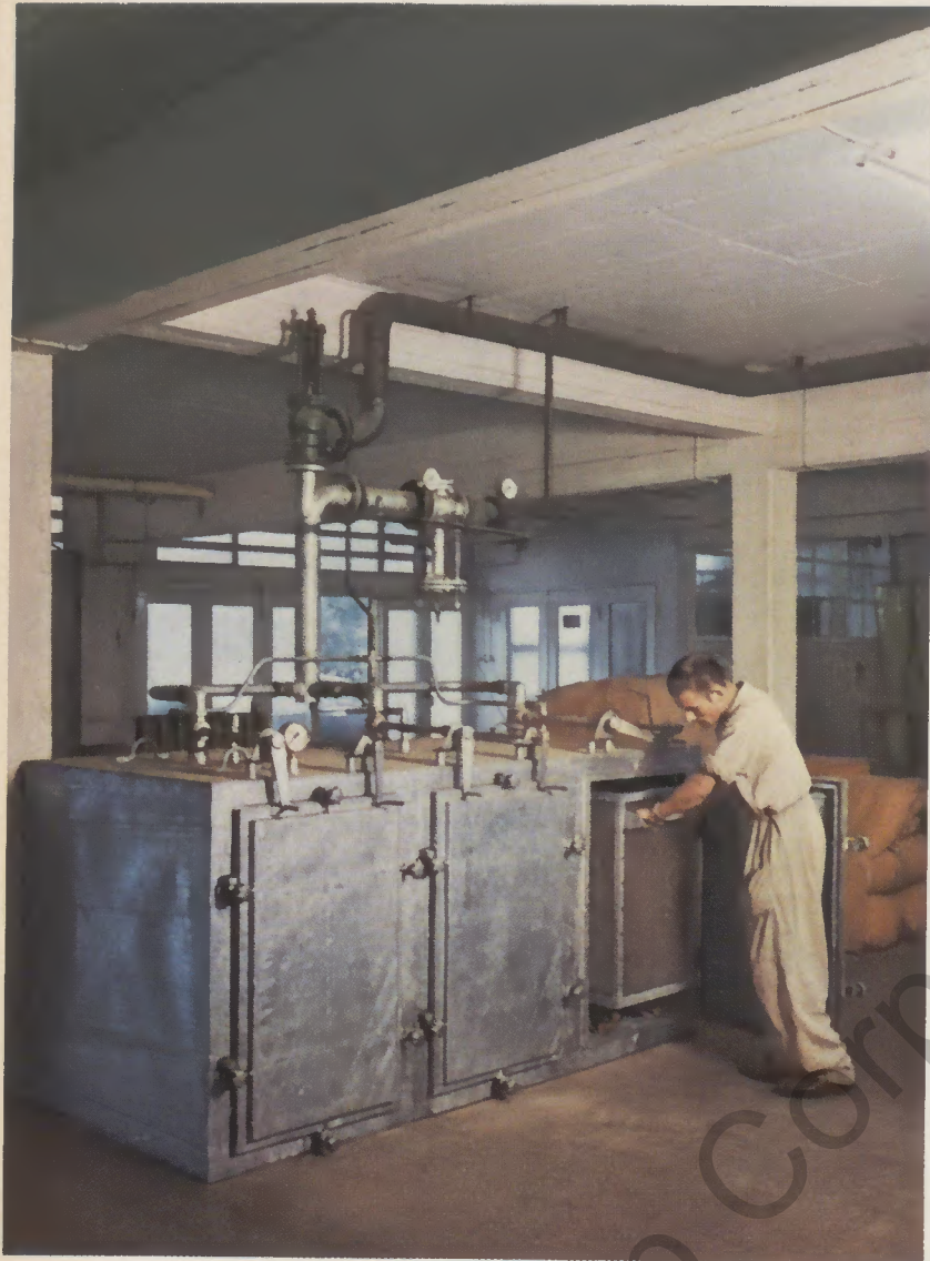
Abb. 9 Auch dieser Trommeltrockner im Roha-Werk wurde von Henschel gebaut
