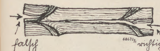
Abb. 1: Das Aufreißen des Tannenstempels gelingt — aber nur vom dünnen Ende aus
