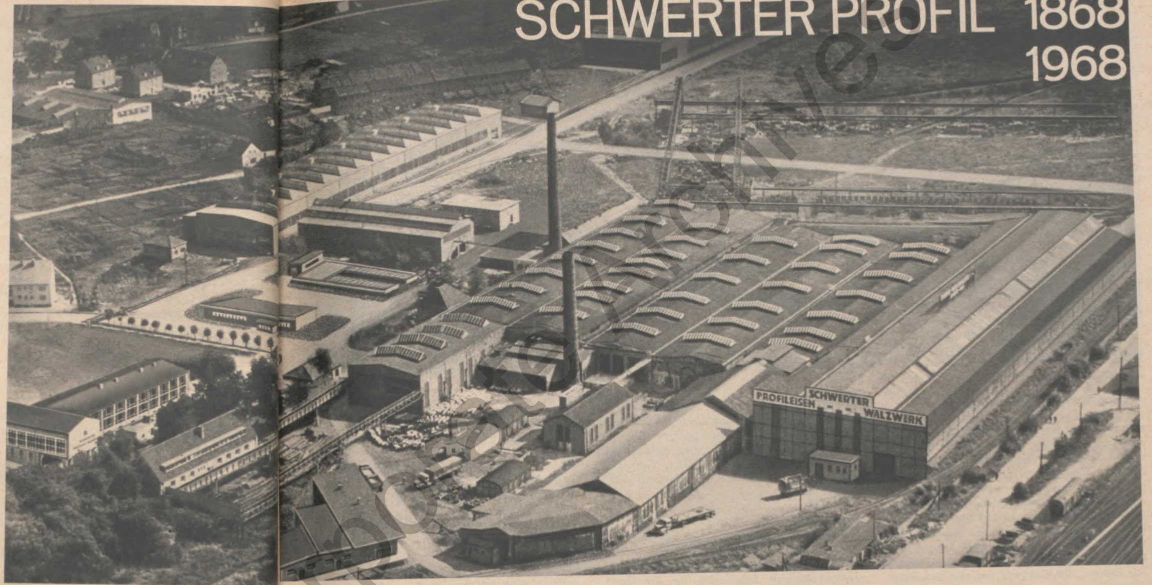
▲ 1968: Blick auf die Werksanlagen des Schwerter Profileisenwalzwerks: im Mittelpunkt stehen die Walzwerkshallen (nicht mehr sichtbar ist die neue Walzstraße 7), ganz links sind die Verwaltungsgebäude erkennbar, und links oben liegen an der Werkstraße das Ziehwerk und dahinter das Preßwerk
