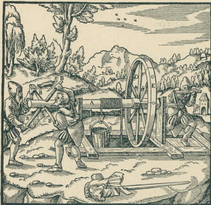
Abb. 1. Schachtförderung durch eine Haspelwelle. Abb. 2. Schachtförderung durch die „runde Scheibe“. (Aus Georg Agricola: „Zwölf Bücher vom Berg- und Hüttenwesen“, Lateinische Ausgabe 1556.)
