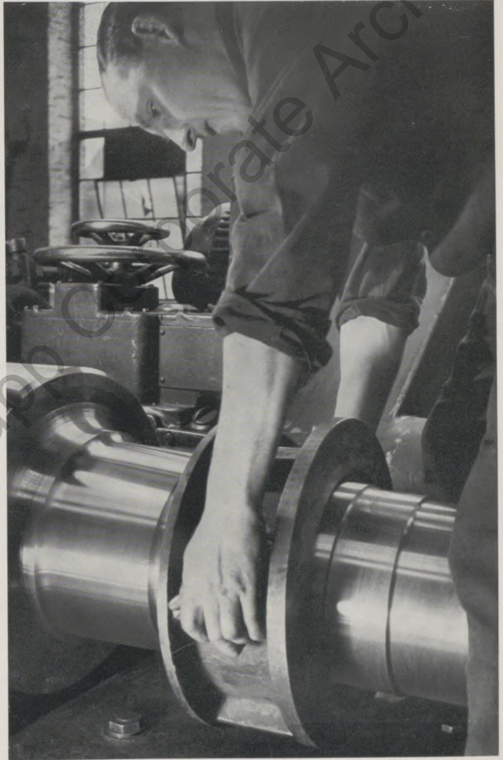
Schleifen der Konen an einer Stülkwalze und Aufpassen des Konustalibers
