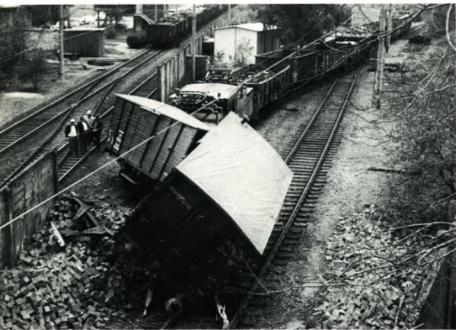
Durch mangelhafte Fahrwegbeobachtung, falsches Einschätzen des Gleisgefälles und der Anhängelast kam es zu einem Auffahrunfall. Schadenskosten ca. DM 12 500,–
