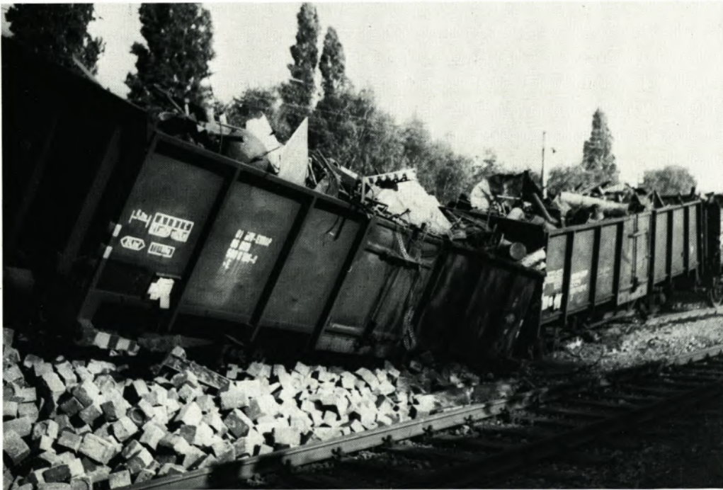
Durch mangelhafte Fahrwegbeobachtung, falsches Einschätzen des Gleisgefälles und der Anhängelast kam es zu einem Auffahrunfall. Schadenskosten ca. DM 12 500,–
