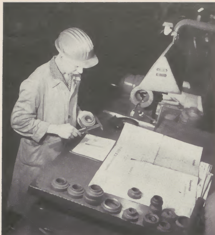
Produktionskontrolleur Friedhelm Strock beim Vermessen der Stichprobe (technisch statistische Qualitäts-Kontrolle).
