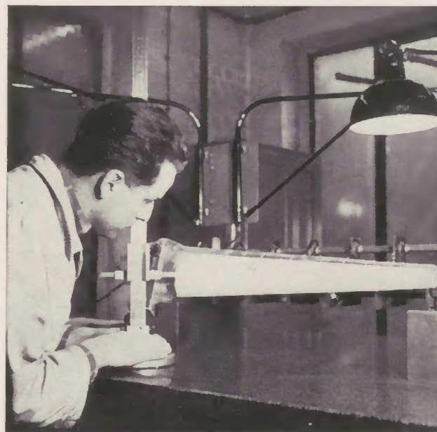
Anreißer Arno Felix beim Anreißen des Gipsabgusses eines Turbinenschaufelgesenkes.
