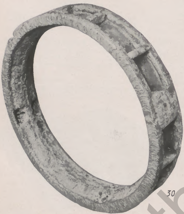
Abb. 82: Bronzering einer Schleifkupplung, autogen geschweißt
