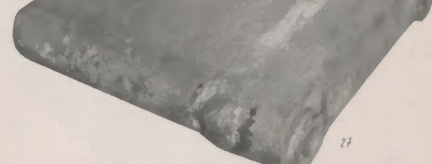
Abb. 79: Geschweißter kupferner Wassertühlkasten wie Abb. 78
