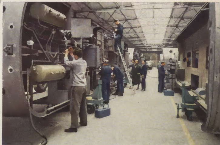
Abb. 12 In diesem Takt können ohne Überkopparbeit alle Geräte und Leitungen an der hochkant stehenden Unterschale montiert werden
