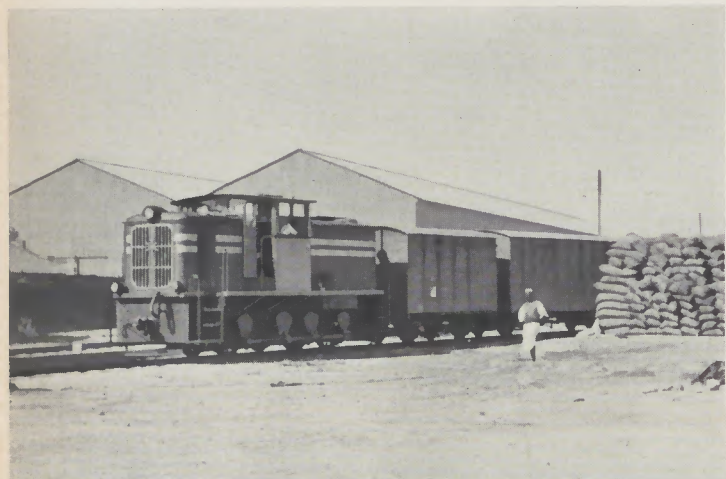
Abb. 5 Diesel-hydraulische Henschel-Lokomotive Typ DH 400 beim Einsatz in Port Sudan
