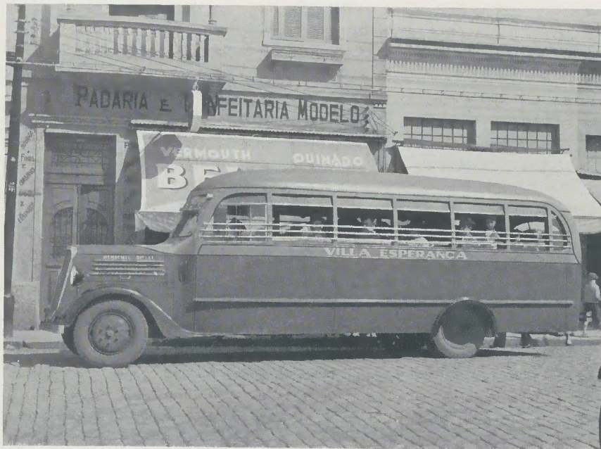
Omnibus mit einem Henschel-Fahrgestell in Sao-Paulo Die Aufbauten werden gewöhnlich im Bestimmungsland hergestellt, um den Zoll zu sparen. Sie sind für unsere Begriffe daher oft etwas plump und einfach
