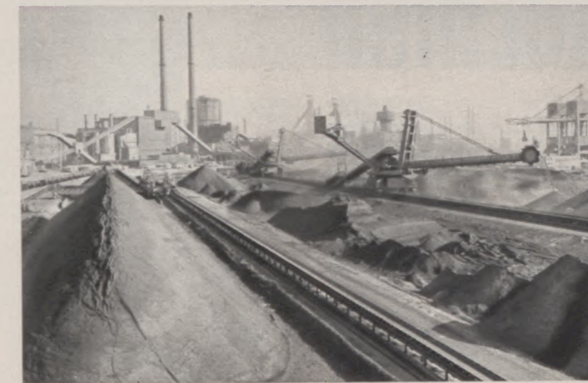
Von den Verteilungsbunkern läuft das Erz – wie die Kohle – über ein verzweigtes Bandsystem zu den Lagerfeldern
