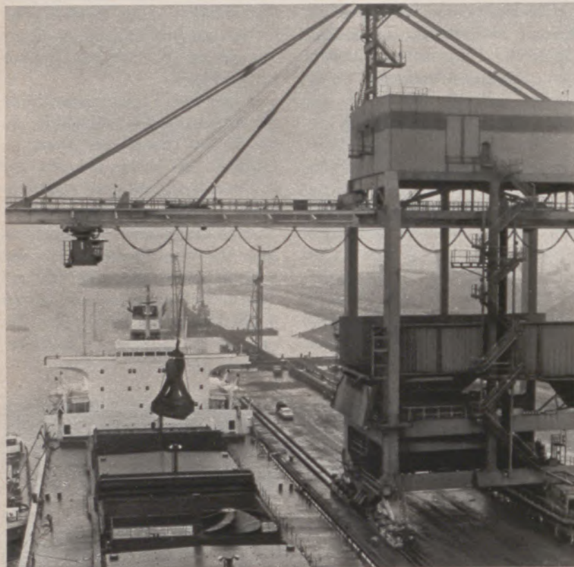
Vor den Hochöfen 1 bis 5 liegt der älteste Hafenteil von Hoogovens, in dem heute die kleineren Schiffe festmachen (im Hintergrund). Vorn der Außenhafen 3, in dem der Hauptteil der für den Export bestimmten Hoogovens-Erzeugnisse von zwei Portalkranen verladen wird
