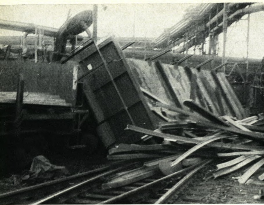
Eine Flankenfahrt brachte diesen beladenen SS-Wagen zum Umstürzen. Drei weitere Wagen entgleisten und wurden beschädigt. Gesamtkosten ca. DM 14000.
