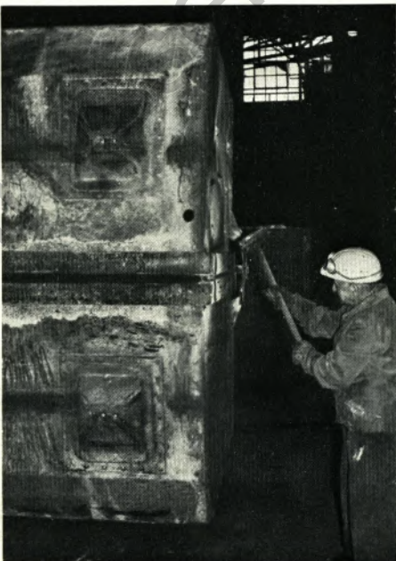
Manchmal wird bei Richtarbeiten auch noch zum Hammer gegriffen, in der Regel helfen heute aber hydraulische Pumpen und Pressen die Arbeit zu erleichtern.
