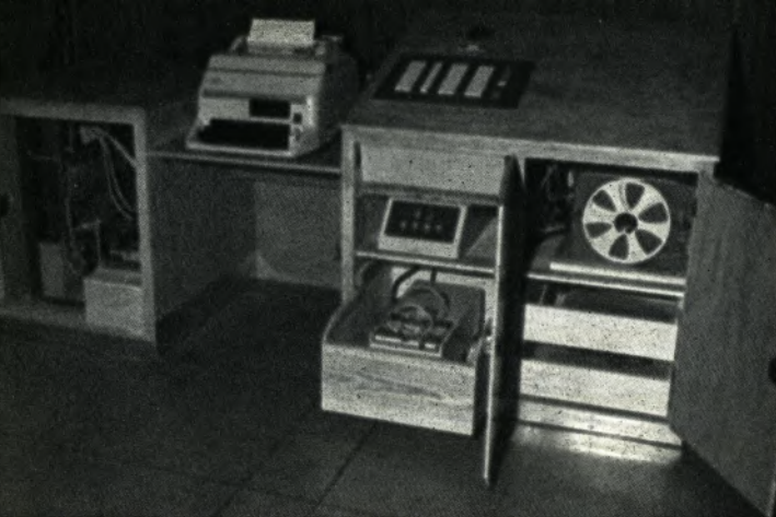
Auf diesem Fernschreiber mit Blocktastatur wird der Rangierzettel und gleichzeitig der Lochstreifen für die eigentliche Ablaufsteuerung erstellt.
