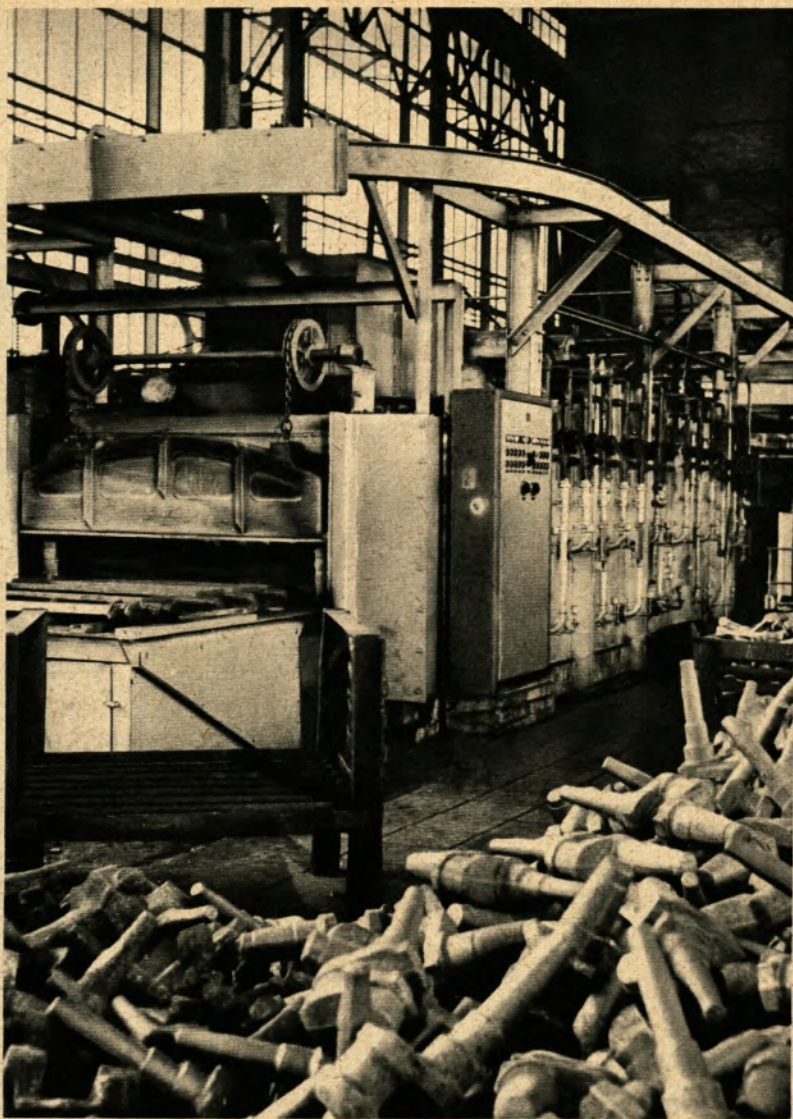
▲ Zu den Neuinvestitionen der Schmiedag AG gehört auch die neue Vergüeanlage, deren Durchlaufofen unser Bild zeigt. Im Vordergrund geschmiedete Achsschenkelbolzen und Kurbelwellen
