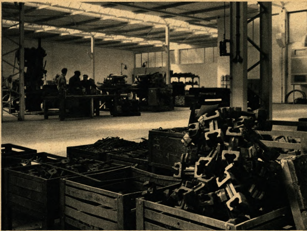
▲ Dieser Einblick in die neuerbaute Werkhalle III der Dörken AG in Gevelsberg zeigt im Vordergrund Fertigerzeugnisse und im Hintergrund die Maschinengruppe der Schalenmuffenfertigung
