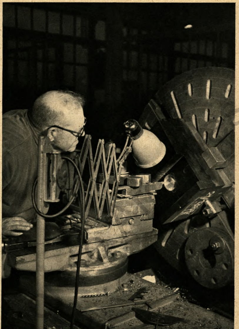
▲ Äußerste Genauigkeit verlangt die Herstellung eines neuen Gesenkes. Dreher Otto Krause von der Schmiedag AG hat sich ganz auf seine Arbeit konzentriert
