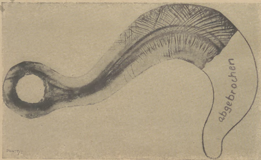
Ein gebrochener und längs aufgeschnittener Kranhaken
