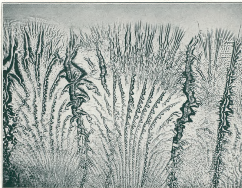
Abb. 3. Im Quecksilberdampflicht getrockneter Holzölfilm. Saltbildung in 70facher Vergrößerung.
