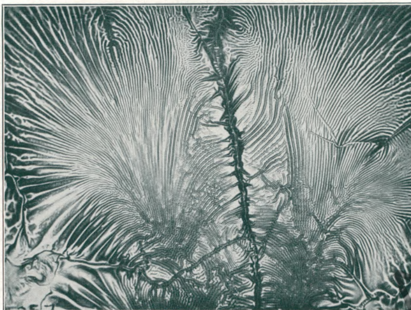
Abb. 1. Eisblumenererscheinung bei Holzölfilmen. Mikrophotographie mit 70 facher Vergrößerung einer Stoßfalte.
