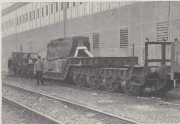
Transport eines 70 t-Hammerteiles auf einem Spezialwagen durch unseren Eisenbahnbetrieb
