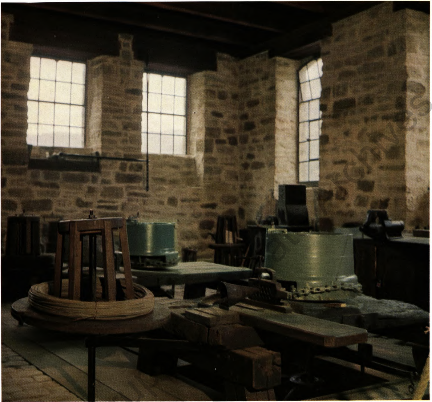
Blick ins Innere der Pfeffermühle. In der Mitte zwei Ziehscheiben, vor der rechten Ziehscheibe ist das Holeisen (Zieheisen mit mehreren Löchern für verschiedene Durchmesser) deutlich zu erkennen.
