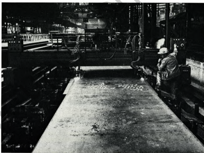
Brennschneideanlage beim Besäumen eines Grobbleches. Ein Mit-arbeiter reguliert die Brenner mittels Fernbedienung.
