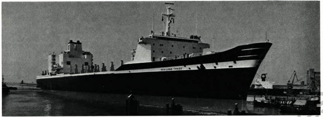
Die Sea-Land Trade gehört zu den schnellen Containerschiffen der dritten Generation. Mit einer Dampfturbinenleistung von zweimal 60 000 PS fährt sie 1 800 Container (zwanzig Fuß) mit 33 Knoten
